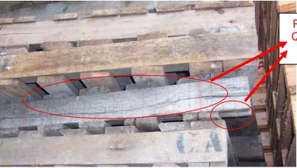
Pallet en mal estado = rechazado Quebrado soporte lateral y le falta una tabla del borde
