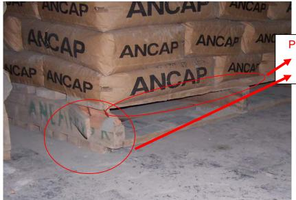
Pallet en mal estado = rechazado Quebrada primer tabla y soporte lateral.
