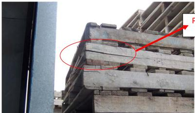
Pallet en mal estado = rechazado Quebrado soporte lateral
